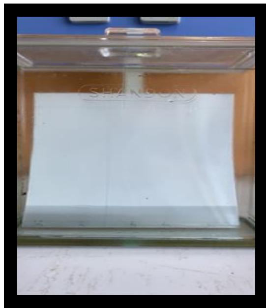
**Figure 16 :** Préparation de la plaque CCM
