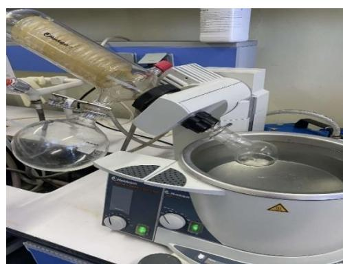
**Figure 15 :** Evaporation sous vide à l'aide d'un rotavapeur
